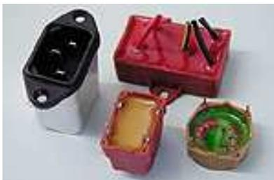
Mit Polyurethanharzen eingekapselte elektronische Komponenten durch einen kartesischen Roboter und lineare Interpolation.
